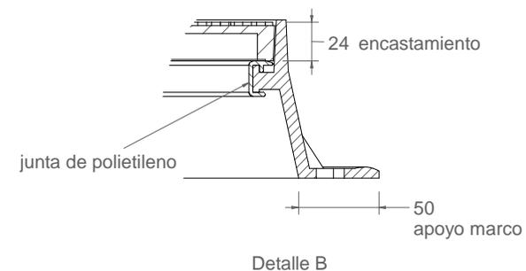
Material: Fundición Ductil GGG40
