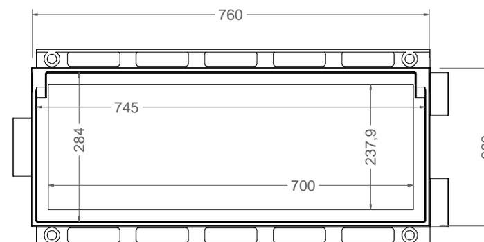
Material: Fundicion ductil GGG40
