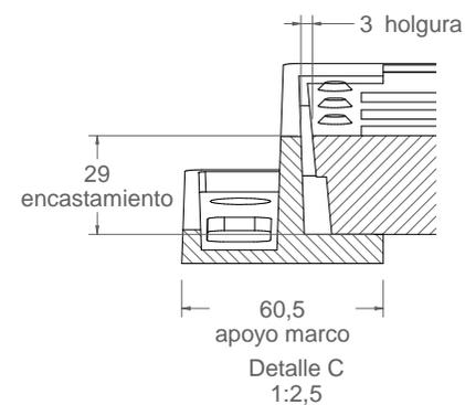
Material: Fundicion ductil GGG40
